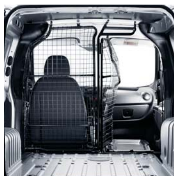
Keičiamos formos pertvara, komplektuojama su sulankstomąja keleivio sėdyne**.
